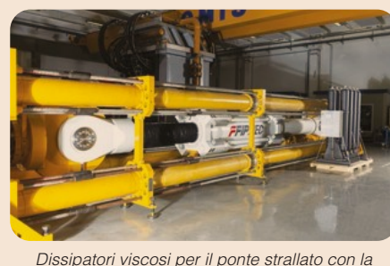
Dissipatori viscosi per il ponte stralato con la campata sospesa più lunga al mondo - 1915 Canakkale Bridge (Turchia)
